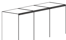
Montagem do batente central (apenas para aplicações 3 portas)
